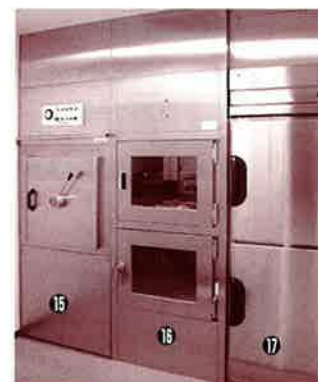
⑮サーバスチーマー ⑯ファームウォッシャー ⑰冷蔵バスボックス
