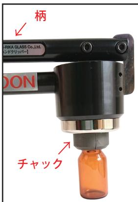
③押し当てた状態を保ちながら、ハンドクリッパーの柄を静かに握りしめる。(完全に握り込む前に、瓶を軽く回しながら締めると、より確実に締まる。)
