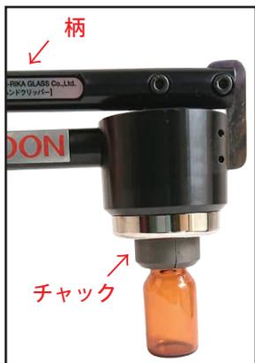
③押し当てた状態を保ちながら、ハンドクリッパーの柄を静かに握りしめる。(完全に握り込む前に、瓶を軽く回しながら締めると、より確実に締まる。)
